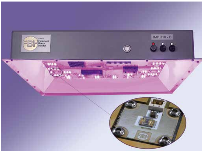
UV-B-Modul zur Pflanzenbestrahlung mit verschiedenen LEDs: UV (310 nm), blau (451 nm), rot (660 nm). Die LEDs können separat eingestellt werden, um das optimale Licht für gesundheitsfördernde Pflanzenstoffe zu ermitteln (Detailaufnahme: LED) © FBH/P. Immerz
