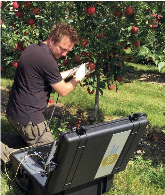
Am FBH wurde ein portables Raman-Lasersystem für den Feldeinsatz entwickelt, hier auf einer Obstplantage © FBH/A. Müller
