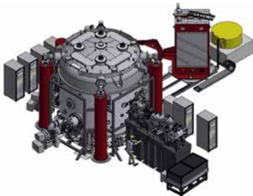
Reflektometersystem für große Proben (Probendurchmesser bis 1500 mm, Gesamtlast bis 800 kg) mit integrierter Quelle und Monochromatorstrahlrohr für den Wellenlängenbereich von 6nm–20nm.
