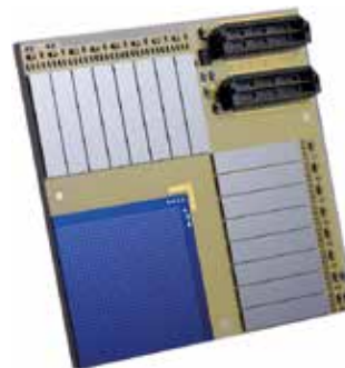
Hochkomplexe Baugruppe aus Mikrosiegeln © AEMtec GmbH
