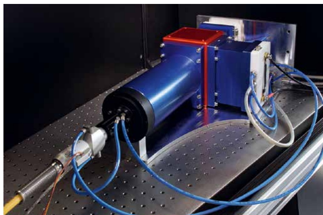
Pumpmodul für Hochenergie-KurzpulsLasersysteme mit circa 6 kW Ausgangsleistung aus der Faser © FBH/P. Immerz
